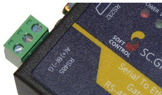
Figur 2 Viser stik til RS485 tilslutning
