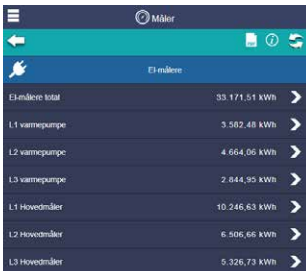
Figur 1 Viser en installation med 6 el-målere tilkoblet installationen. Ved at klikke på højrepilen, f.eks ud for L1 varmepumpe så fremkommer Figur 2.
