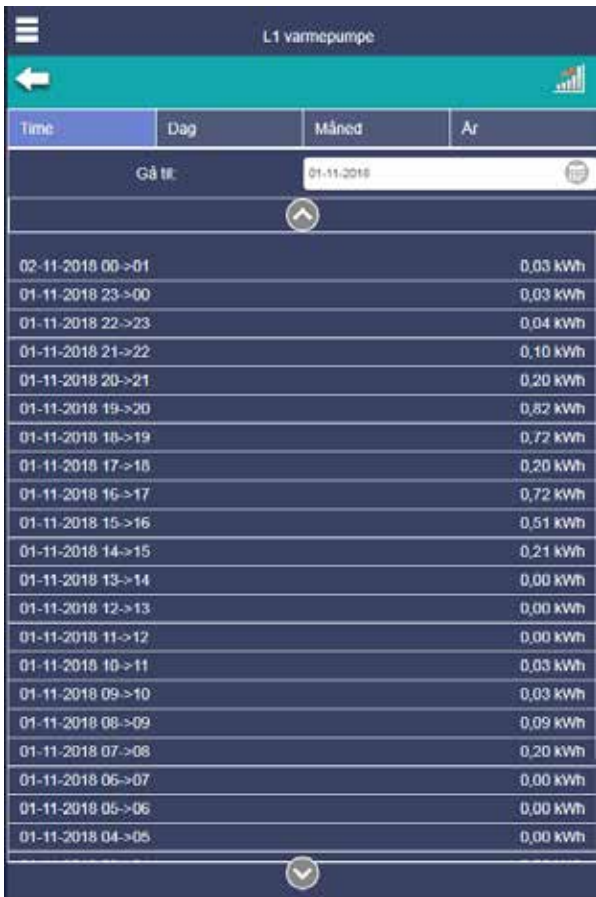
Figur 3 Den visning som fremkommer når der trykkes på bargraf ikonet under time visning på Figur 1.
