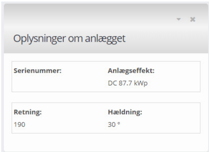
Figur 16 Tekniske informationer på anlægget.
